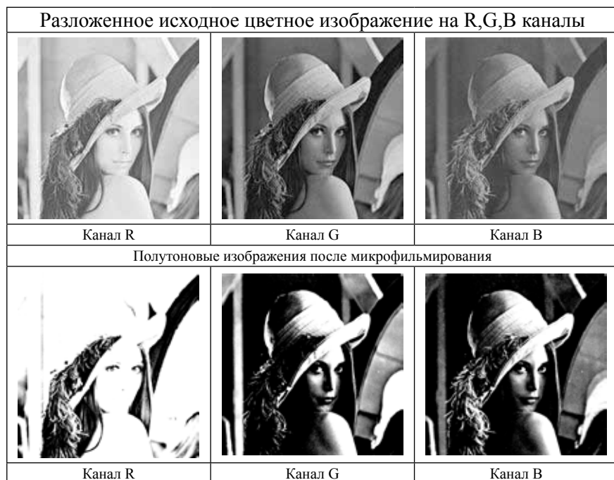
Рисунок 5 – Результаты разложения исходного цветного изображения на три R, G, B компоненты и результаты микрофильмирования этих компонентов на черно-белой фотопленке
