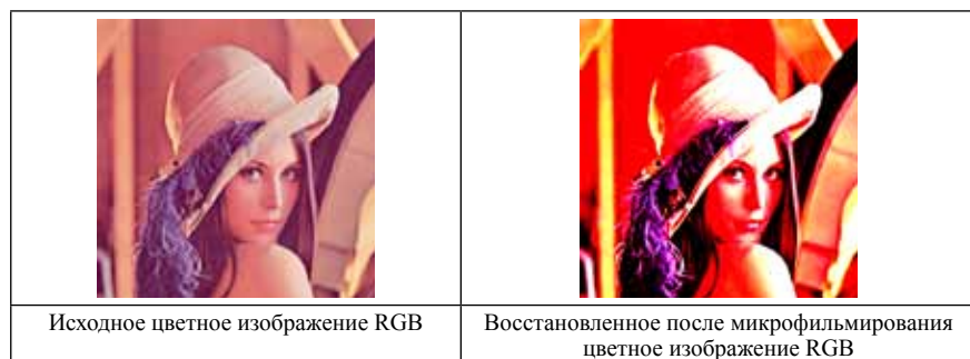
Рисунок 4 – Пример исходного цветного изображения выполненного в RGB цветовом пространстве и восстановленного после микрофильмирования.
